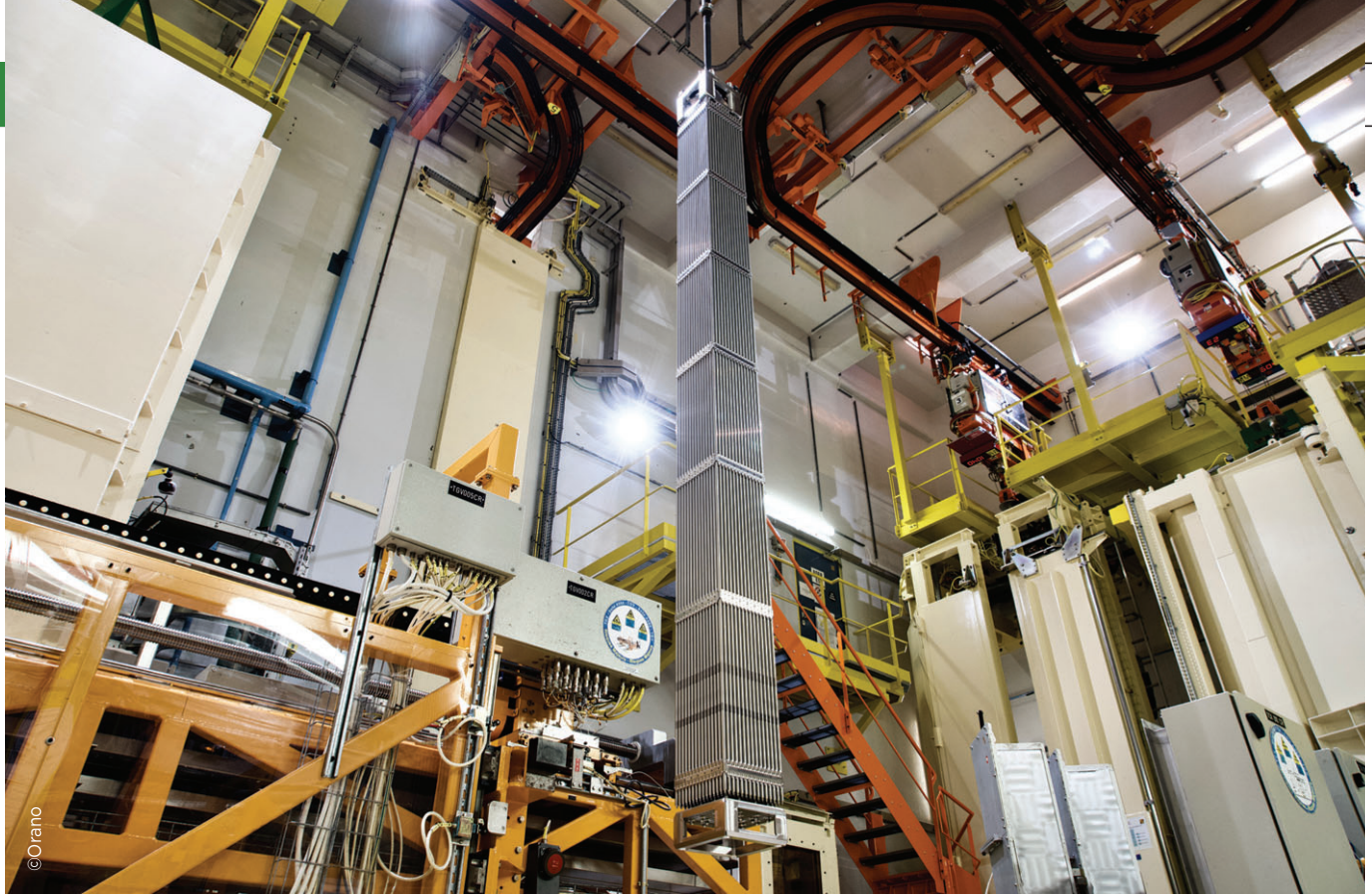
Chargement d'assemblages de combustible MOX sur l'usine de fabrication à Melox.
